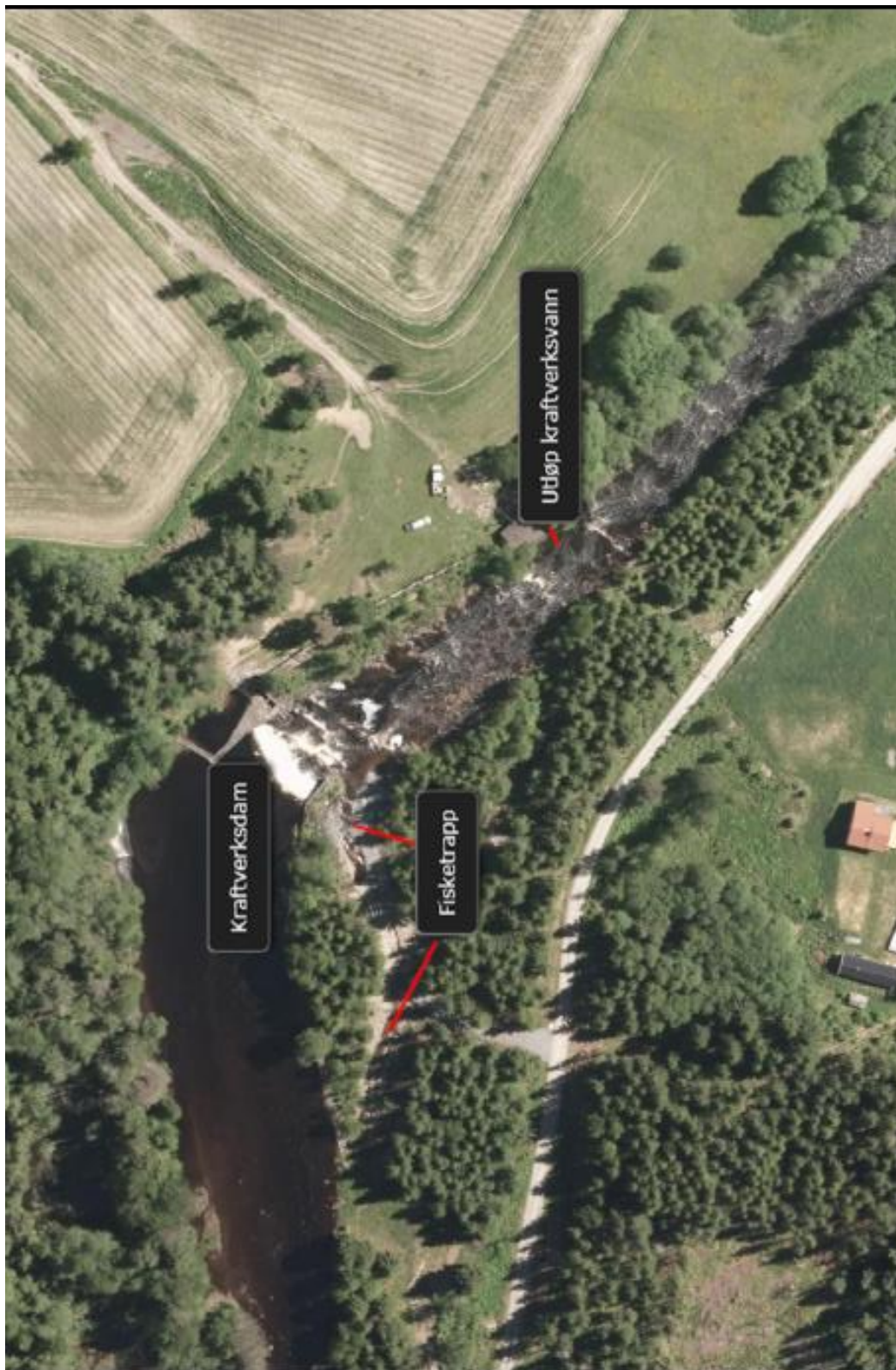
Ortofoto 1: Viser kraftverksdammen, etablert fiske-trapp og utløpspunktet for kraftvannet. Hovedproblemet er at fiske-trappa ikke fungerer tilfredsstillende på grunn av usikker vannføring i gytevandringstiden. Et enkelt tiltak som slipp av minstevannsføring i aktuell periode vil kunne bety mye.
